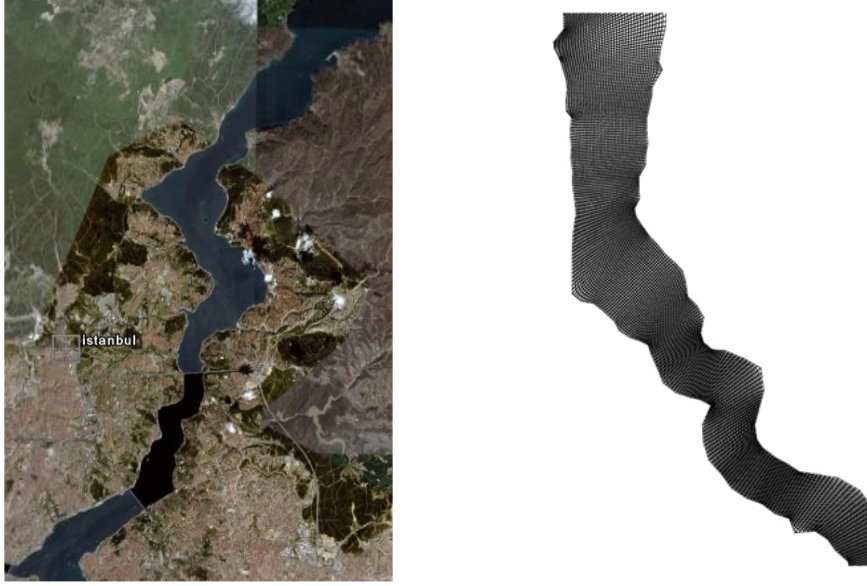
Şekil 7. İstanbul Boğazı'nın uydu fotoğrafı ve üretilen gridlerin yakın plan parçası.
